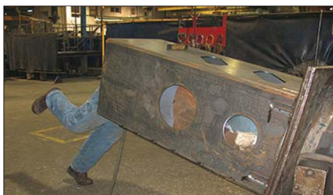
a) Hegesztés a kezek test előtt tartásával. Veszélye: támaszkodás kemény felületen, a kinyújtott kar tartása hosszú ideig.
