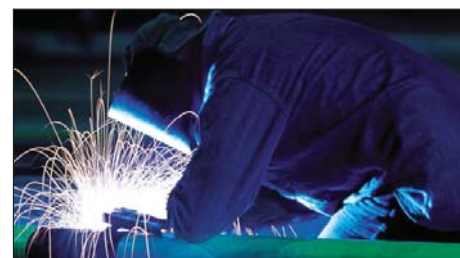
f) Precíziós hegesztés talajszinten. Veszélye: támaszkodás kézzel, térdelés kemény felületen, munkavégzés előredőlt háttal.
