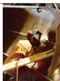
i) Hegesztés görnyedt törzssel. Veszélye: az előregörnyedt testtartás mozdulatlan tartása
