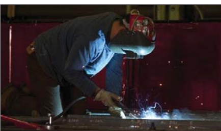
e) Hegesztés a törzs előredöntésével. Veszélye: térdelés kemény felületen és munkavégzés előredőlt háttal.
