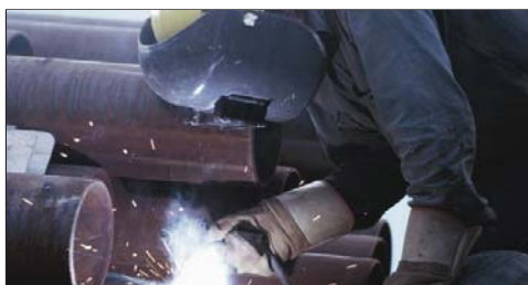
d) Hegesztés a törzs előre döntésével. Veszélye: támaszkodás kemény és éles felületen, munkavégzés előredőlt háttal és kifeszített csuklóval.
