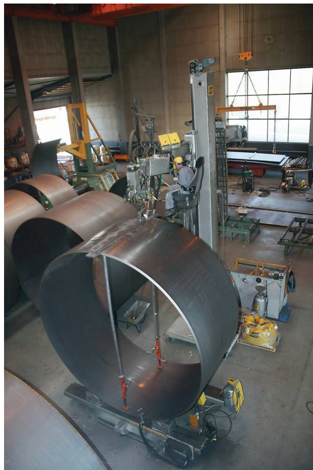
H13-9. ábra Nagy terjedelmű munkadarab hegesztése forgatón (ESAB)
