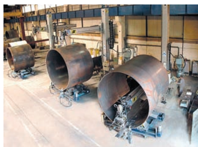
H13-5. ábra Forgató berendezés és állványos hegesztőgép [ESAB]
