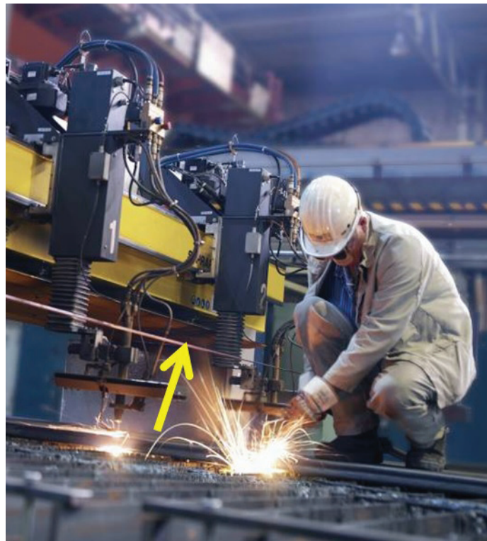
H16-2. ábra. Akadályérzékelő szerkezet lángvágógépen (a nyíl mutatja a kifeszített kötelet) [ESAB MediaBank]
