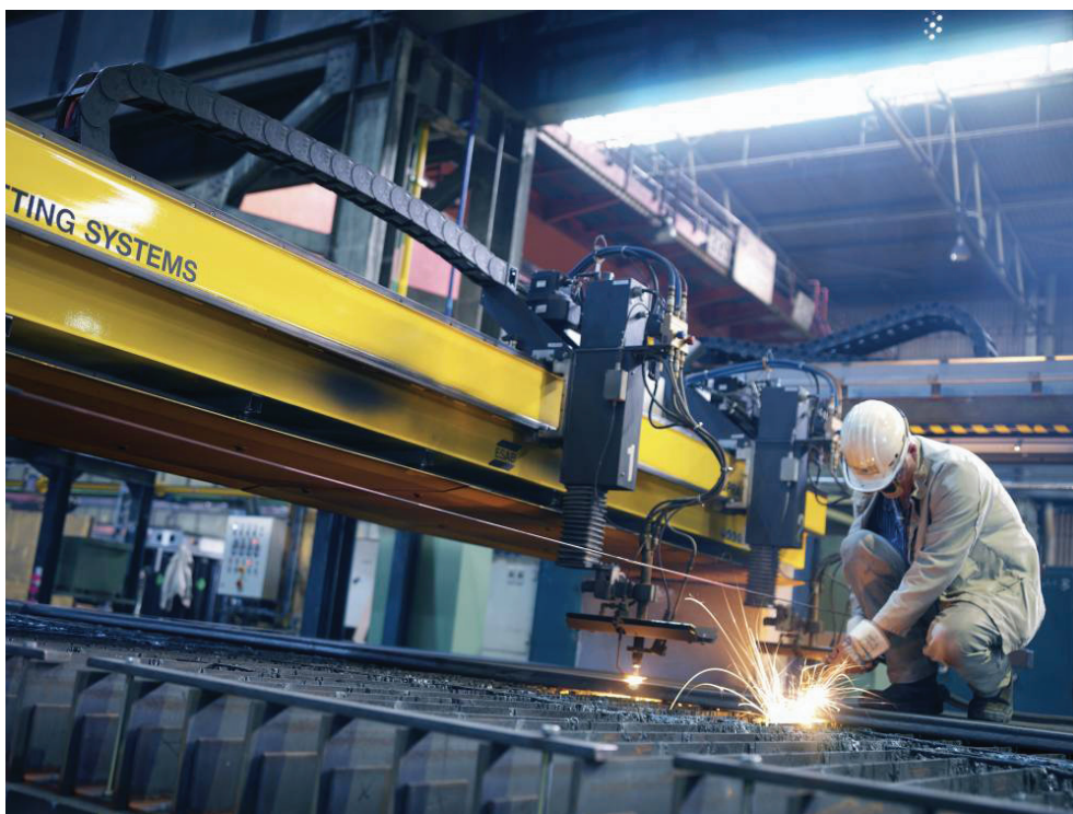
H16-1. ábra. Hulladék átvágása kézi lángvágással CNC vezérlésű vágógép működése közben [ESAB MediaBank]
