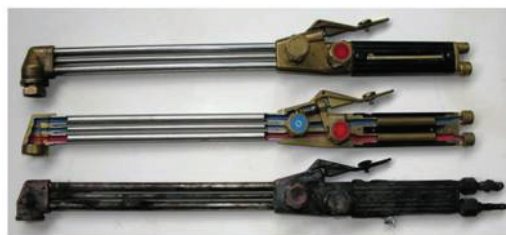
H20-7. ábra Vágópuska károsodás
