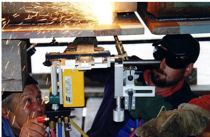
H4-2. ábra Lángvágási munka végzése gépi mozgatású vágófejvel (Fotó: Dr. Domanovszky Sándor)
