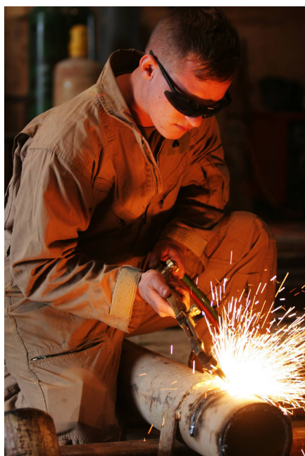
H4-1. ábra Lángvágási munka végzése kézi vágópisztollyal (Wikipedia)
