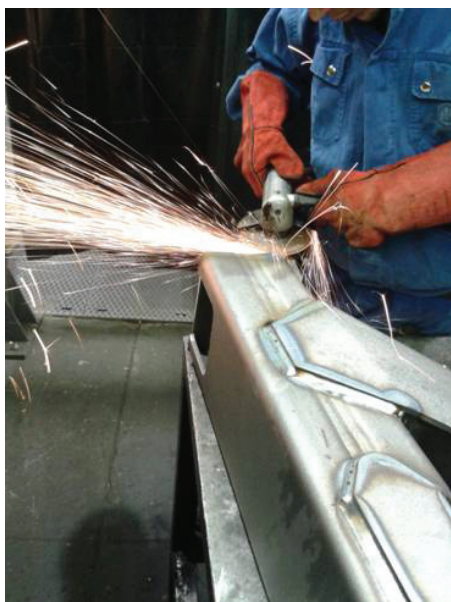
Hegesztési hibák, fröcskölések eltávolítása kézi köszörűgéppel [fotó: Virág Balázs]
