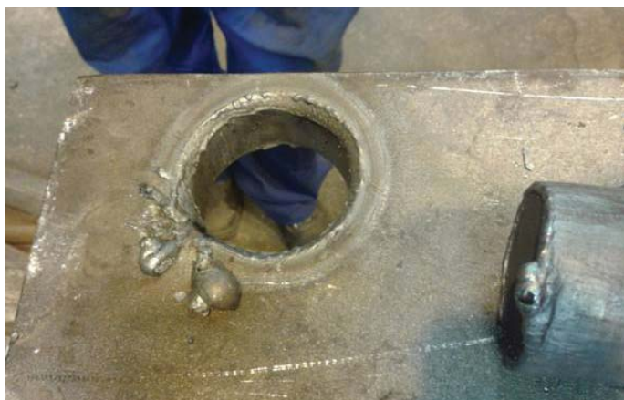
H5-1. ábra Lángvágási munka végzése közben, a forró kivágott alkatrész vizsgálata (fotó: Virág Balázs)
